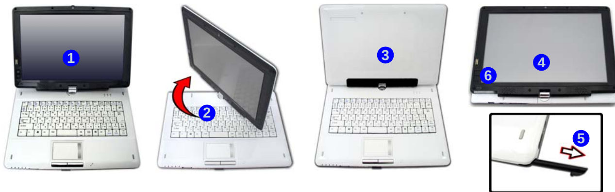
Figura 2 - Girar la pantalla LCD al Modo Tablet
