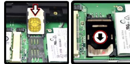
Figura 18 Inserimento della carta USIM & blocco del FERMO DELLA SIM
