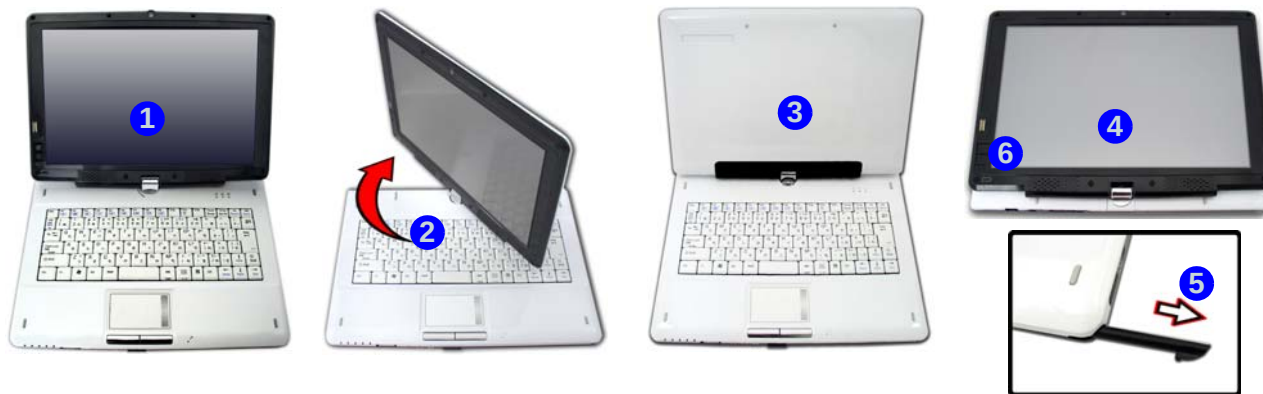
Figura 2 - Rotazione dello schermo LCD in modalità Tablet
