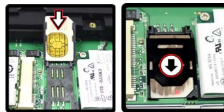
Figure 18 Insérez la carte USIM & verrouillez le SIMLOCK
