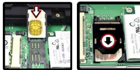
Figura 18 Insertar la tarjeta USIM & bloquear SIMLOCK
