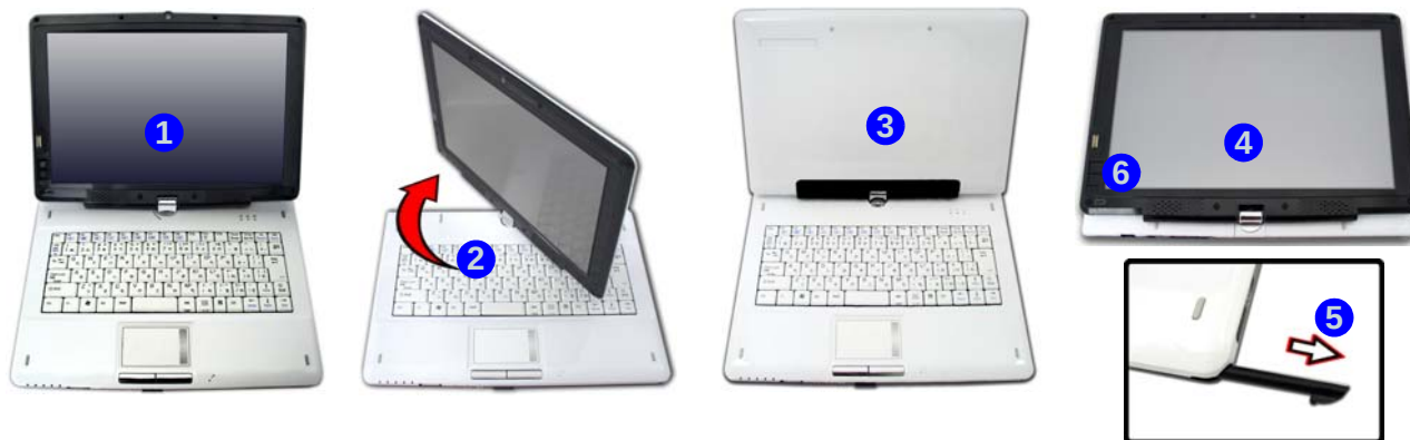
Figure 2 - Rotation de l'écran LCD en Mode Tablet
