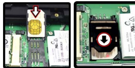
Abb. 18 Einsetzen der USIM-Karte und Schließen des SIM- LOCK-Riegels
