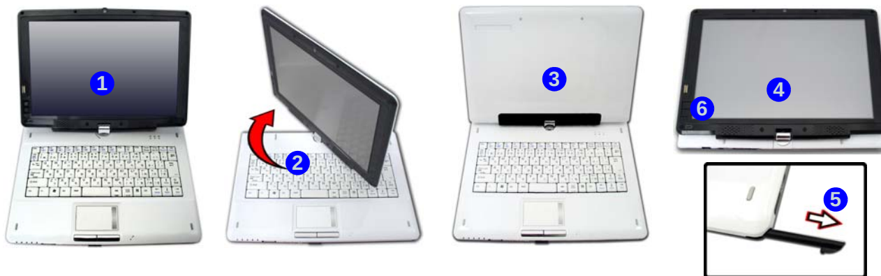
Abb. 2 - Drehen des LCD-Bildschirms in den Tablet-Modus
