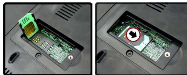
Figura 13 - Inserimento della carta USIM & blocco del FERMO DELLA SIM
