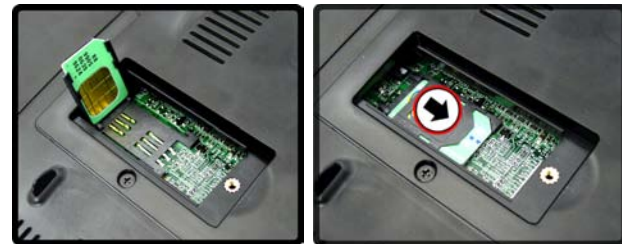
Figura 13 - Insertar la tarjeta USIM & bloquear SIMLOCK
