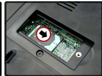
Abb. 13 - Einsetzen der USIM-Karte und Schließen des SIMLOCK-Riegels
