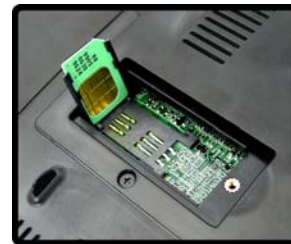
Abb. 13 - Einsetzen der USIM-Karte und Schließen des SIMLOCK-Riegels
