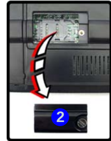
Abb. 12 - Abnehmen der SIM-Kartenfachabdeckung
