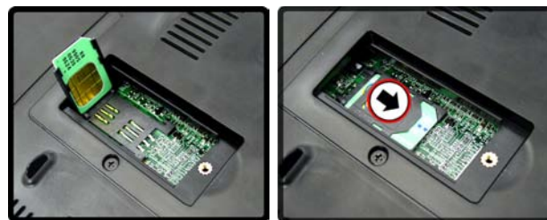
Figure 13 - Insérez la carte USIM & verrouillez le SIMLOCK
