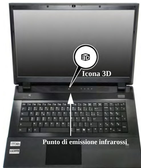
Figura 15 - Punto di emissione infrarossi
